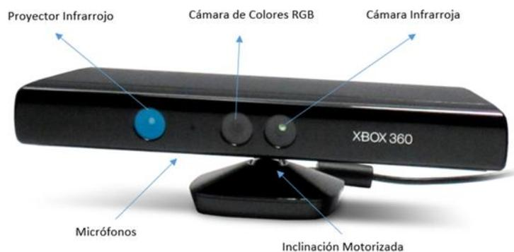
Figura 2. Componentes del Kinect. [16]
