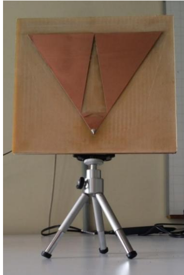
Figura 4.40 Construcción final de la antena con soporte.
