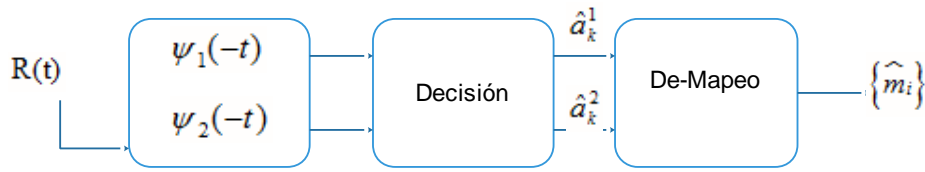
Figura 3.11. Demodulador bidimensional basado en matrices Hadamard
