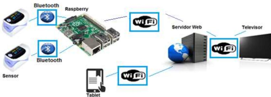
Figura 8. Arquitectura de despliegue del sistema.
