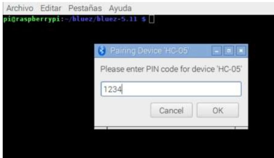
Este mismo emparejamiento se debe realizar con cada uno de los sensores que se quiera agregar al sistema hasta un máximo de 8. Luego de esto se configuro el archivo `rfcomm.conf`, en donde se va a configurar cada dispositivo con su respectiva dirección MAC con el fin de garantizar la seguridad del sistema en cuanto a intromisiones de dispositivos extraños al sistema. Para ingresar a este archivo se digita el siguiente código en la terminal del sistema de Raspberry así:
