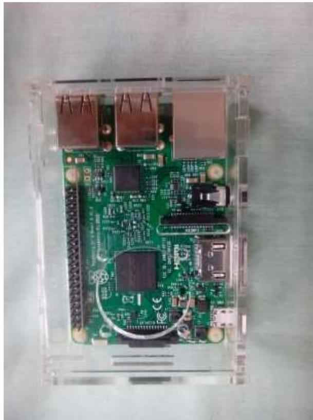
Figura 16. Raspberry Pi 3, usada en el proyecto junto con su caja en acrílico para su protección.
