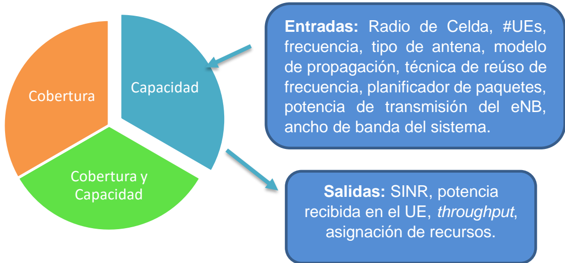
Figura 3.2 Entradas y Salidas del Bloque de Capacidad del Simulador. Fuente: Por autor.
