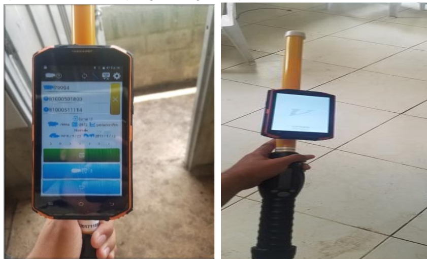
Figura 17. Dispositivo móvil del programa gestal para la identificación de las hembras
