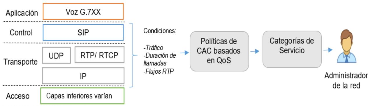
Figura 3-1. Protocolos importantes en la construcción del conjunto de datos.
