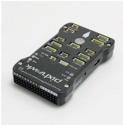
Figura B.7: Controlador de vuelo, Pixhawk.
