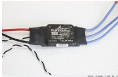
Figura B.4: Controladores de velocidad de 30A.
