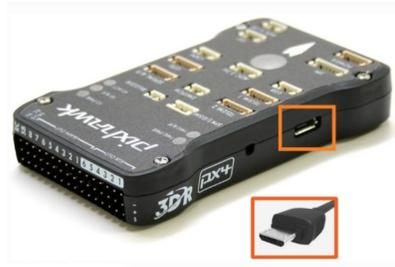
Figura B.16: Carga del firmware en el controlador de vuelo.
