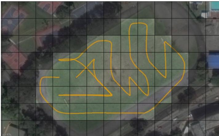
Figura 5.19: Escenario de simulación 3 CDU, ruta frente de onda configuración Moore.
