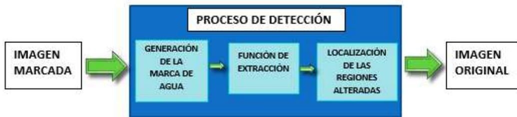
Figura 2.4 Proceso de detección de la marca de agua.
