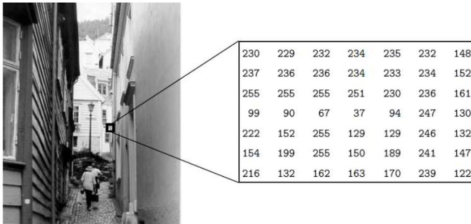
Figura 1.8 Ejemplo de una imagen a escala de grises.
