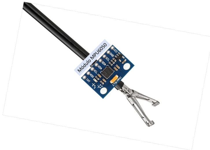
Figura 2.11: Módulo MPU6050 ubicado en la pinza.
