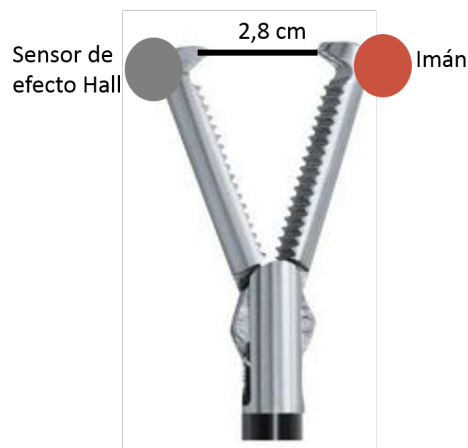
Figura 2.13: Ubicación del sensor e imán
