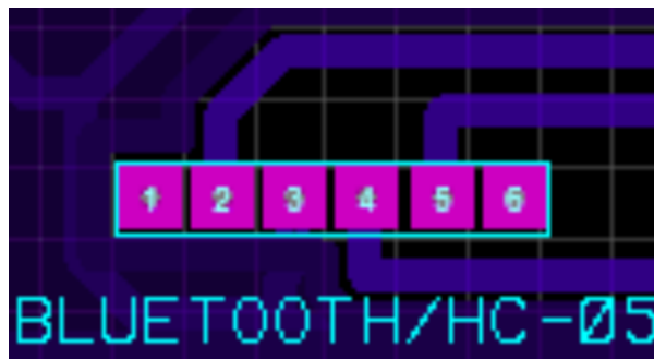
Figura 37: Diseño en Software del Circuito Impreso Modulo Bluetooth HC-05
