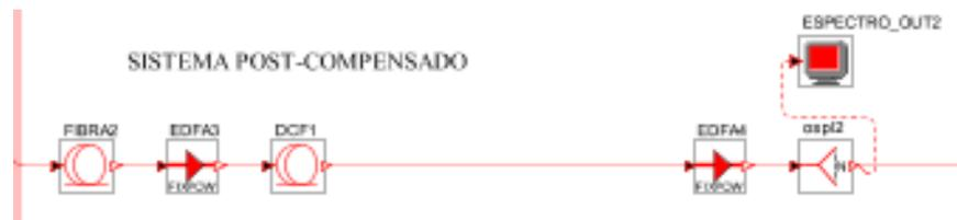
Figura 3.22 Sistema Post-Compensado.
