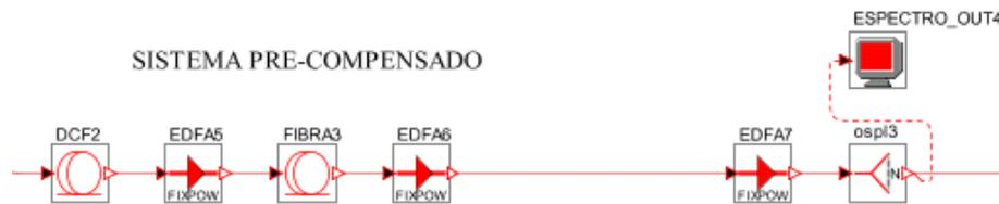
Figura 3.27 Sistema Pre-Compensado.
