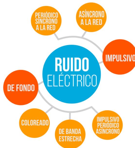
Figura 1 - 7 Tipos de Ruido eléctrico.
