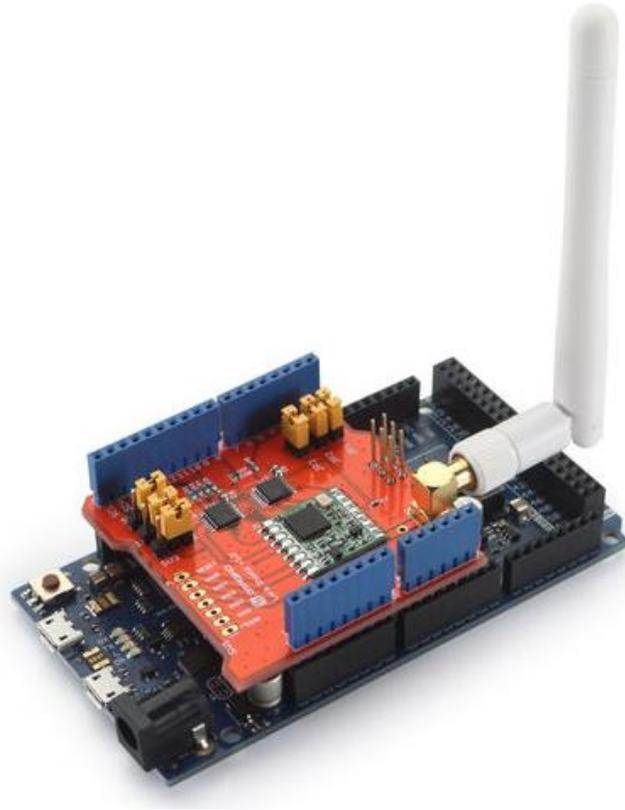
**Figura 4. 34 Dispositivos LoRa Shield V95 y Arduino UNO acoplados**
