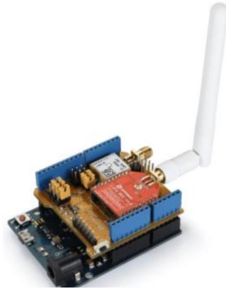
**Figura 4.31** Conexión LoRa/GPS Shield V95 con el Arduino uno.
