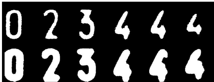
Figura 33. Resultado de la metodología de morfología en grises y binaria y la metodología de detección de blancos con el modelo HSV [Fuente Propia]
