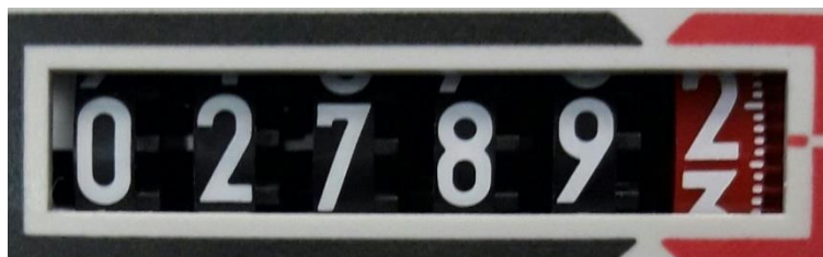
Figura 14. Registrador del medidor con odómetro decimal en transición numérica de 2 a 3 [Fuente Propia]
