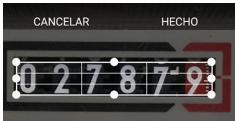
Figura 30. Función crop de Android para la selección manual del ROI [Fuente Propia]
