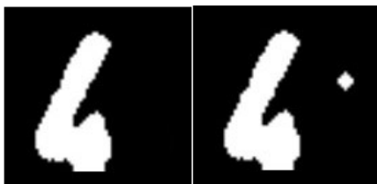
Figura 34. Dígito segmentado individualmente con ruido, antes y después de determinar que la región más pequeña debe ser eliminada [Fuente Propia]
