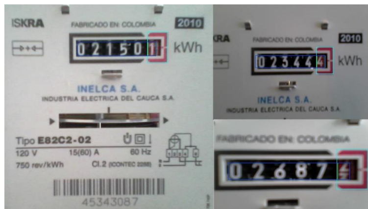
Figura 27. Obtención de la ROI (color azul) en diferentes imágenes de un medidor [Fuente Propia]
