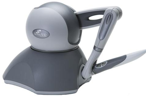
Figura 2.1: Dispositivo háptico *Phantom Omni* [Tomado de <http://www.sensable.com>]
