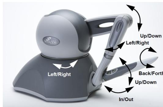
Figura 2.2: Movimientos del dispositivo háptico *Phantom Omni* [Tomado de [70]]
