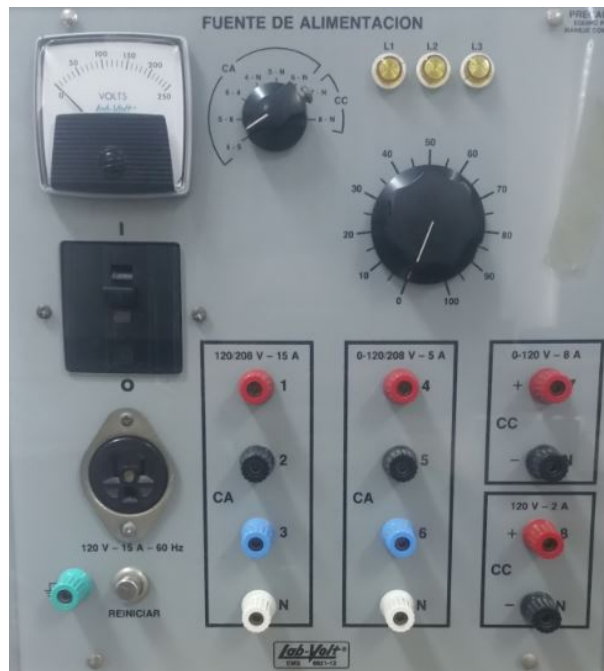
Figura 2.5: Módulo EMS 8821 fuente de alimentación.
