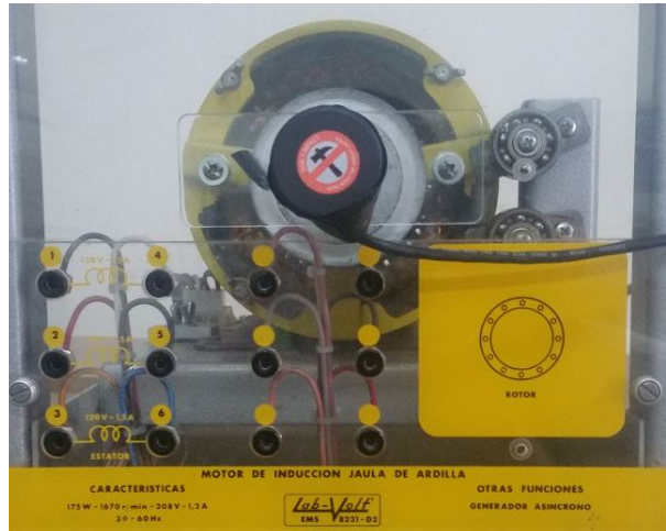
Figura 2.1: Módulo EMS 8221 motor de inducción de jaula de ardilla.
