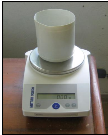
Figura 23. Peso total del material seco con la ayuda de una balanza analítica en el laboratorio de aguas y suelos.
