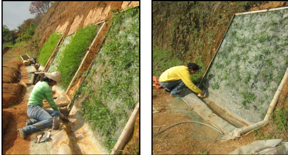
Figura 19. Recolección de sedimentos arrastrados por la erosión y capturados en el receptáculo.
