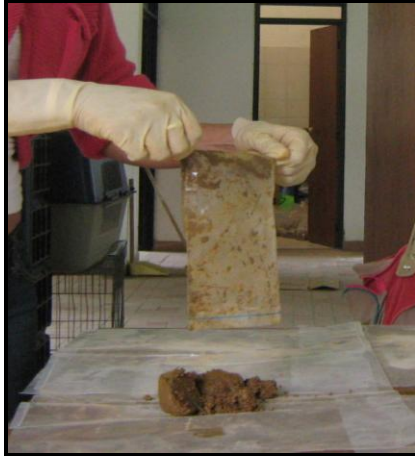
Figura 22. Secado del material a temperatura ambiente en el laboratorio de aguas y suelos.
