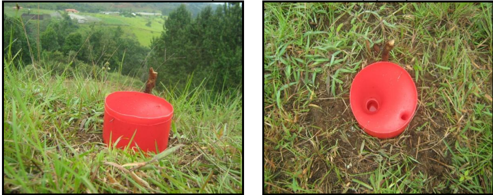
Figura 18. Pluviómetro artesanal enterrado y nivelado en un área despejada y alta.
