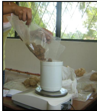
Figura 23. Peso total del material seco con la ayuda de una balanza analítica en el laboratorio de aguas y suelos.
