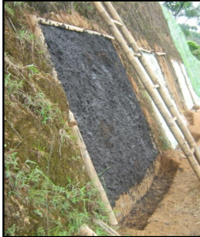
Figura 14. Parcela cubierta por una capa uniforme de lodo fertilizado.
