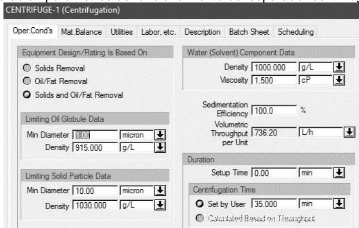
Figura 87: configuración parámetros de funcionamiento del separador centrífugo.
