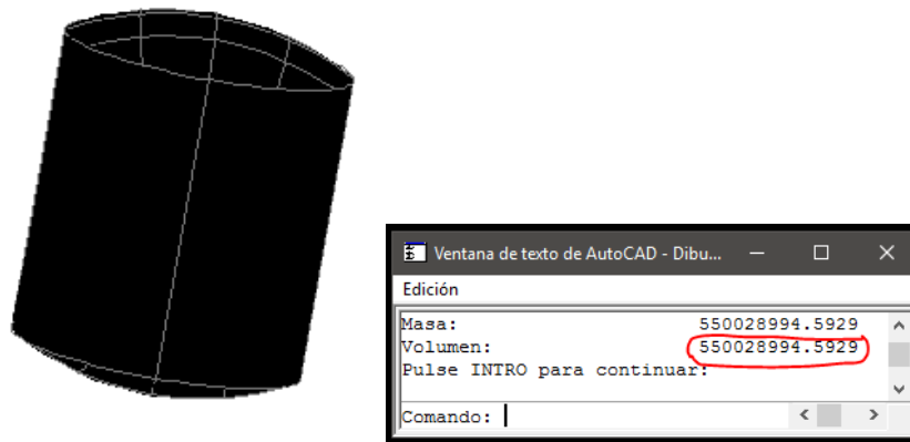
Figura 58: diseño CAD 3D del tanque de almacenamiento.
