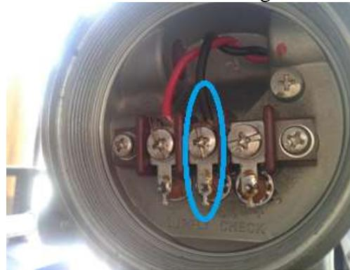
Figura 31. Conexión DPHarp a BT200
