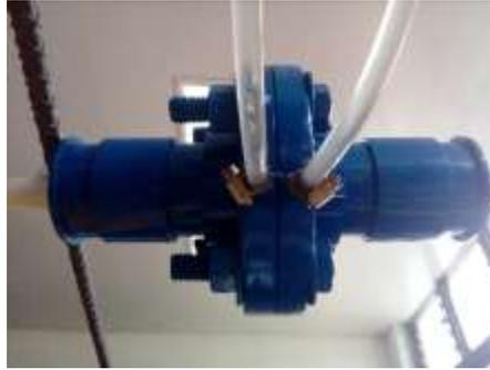
*Figura 33.* Toma de baja presión de la brida.
