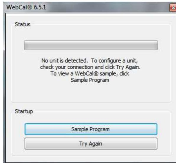
5. Una vez identificado el sensor, debe pulsar el botón **Sample program** para seguir con la calibración del mismo. Aparecerá la ventana de configuración, la cual permite realizar ajustes a los parámetros de medición del sensor ultrasónico (ver Figura 7).
