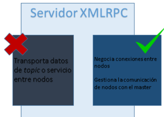
Figura 16. Funciones del servidor XMLRPC. Fuente: propia.
