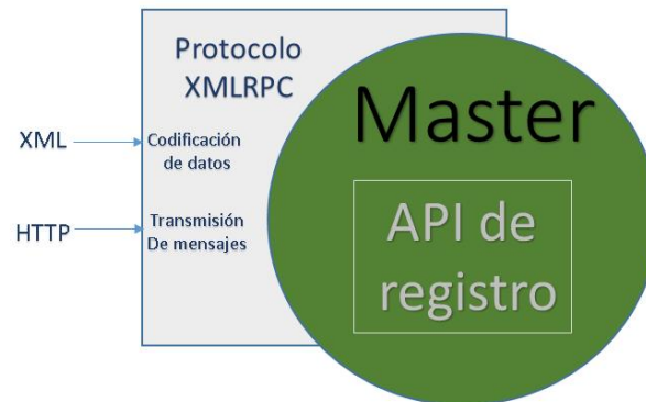
Figura 14. Estructura del Master. Fuente: propia.
