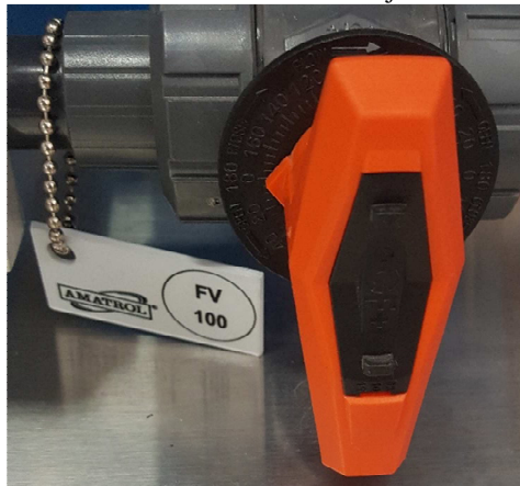
Figura F 5. Válvula de control de flujo manual FV100.
