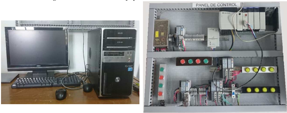
Figura H 4. Estación de trabajo para el laboratorio virtual basado en HILS.
