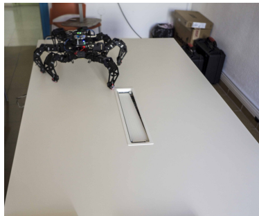
Figura 5.14: Ambiente de pruebas de concavidad. Fuente propia.
