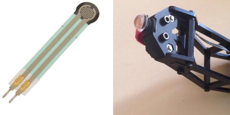
Figura 3.3: Sensor de presión y su instalación en la extremidad. Fuente propia.
