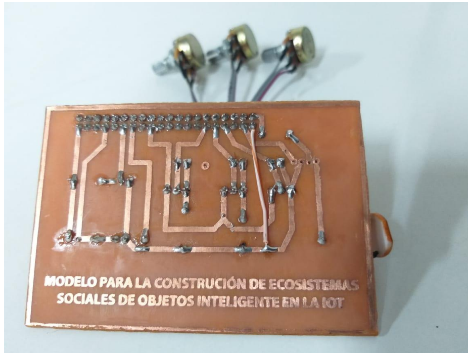
Figura 22: Circuito para el segundo objeto inteligente para el escenario. Fuente propia.
