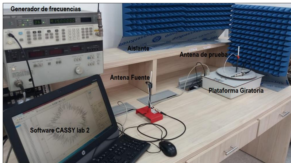
Figura 3.27. Montaje para encontrar el patrón de radiación de la antena LoRa.
