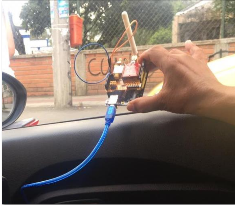
Figura 3.23. Unidad a bordo instalada.
