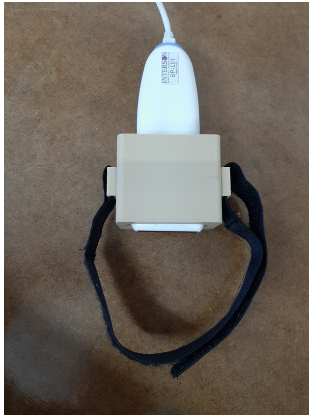
Figura 3.3: Soporte impreso y adaptado a la sonda
