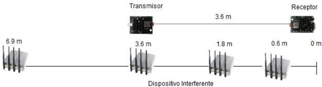
Figura 4.60 Enlace de radio y variación del dispositivo interferente
