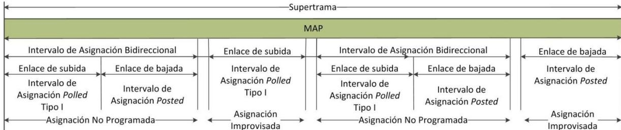
Figura 2.11. Intervalos de Asignación en el MAP en Modo No *Beacon* con Supertrama. Adaptado de [13].
