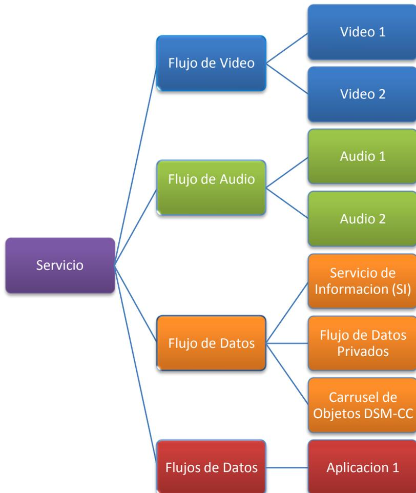
Figura 2. 1 Diagrama de Composición de un Servicio
