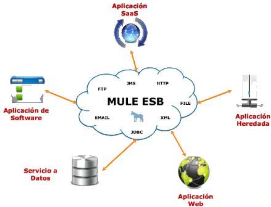
Figura 4. Arquitectura ESB según MULE
