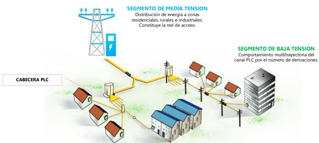
Figura 1.2. Red de suministro de bajo voltaje.
