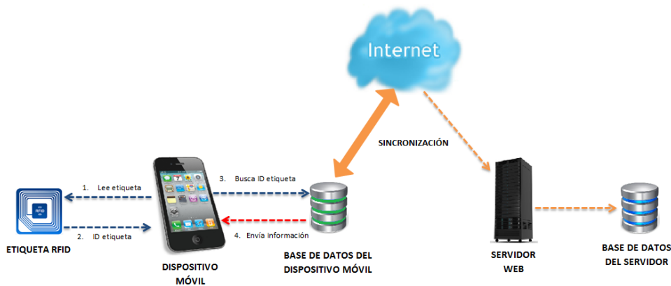
Figura 3.12: Patrón de arquitectura semi-distribuido. Adaptado de[54]
