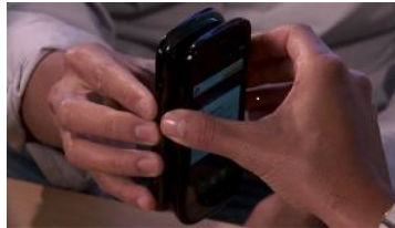
Figura 3.6: Posición de dispositivos móviles para el intercambio de información mediante NFC-P2P
