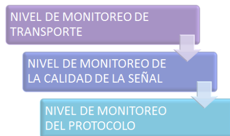
Figura 1.5 Niveles del modelo de referencia OPM [17]
