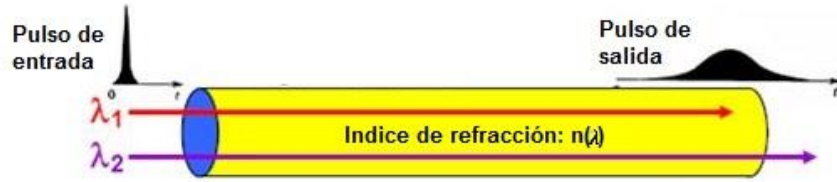
Figura 1.10 Efecto de la CD en los pulsos de la señal óptica [21]
