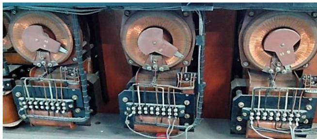
Figura 8. Fuentes de corriente AC de la mesa calibradora
