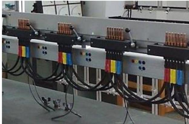
Figura 44. Dispositivos rápidos de conexión de corriente
