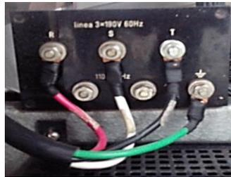
Figura 9. Placa de alimentación de la mesa calibradora
