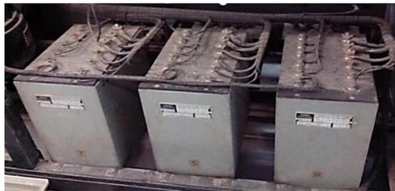
Figura 7. Fuentes de tensión AC de la mesa calibradora
