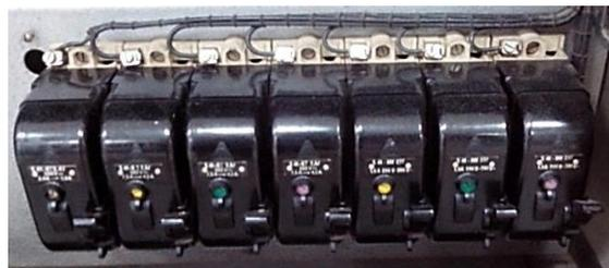
Figura 10. Sistema de protección contra sobrecargas de la mesa calibradora
