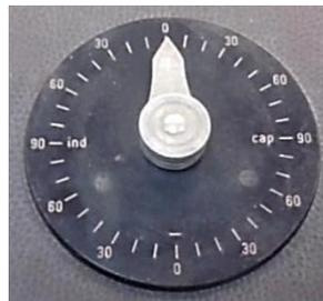
Figura 16. Indicador del ángulo de desfasaje entre la potencia activa y reactiva
