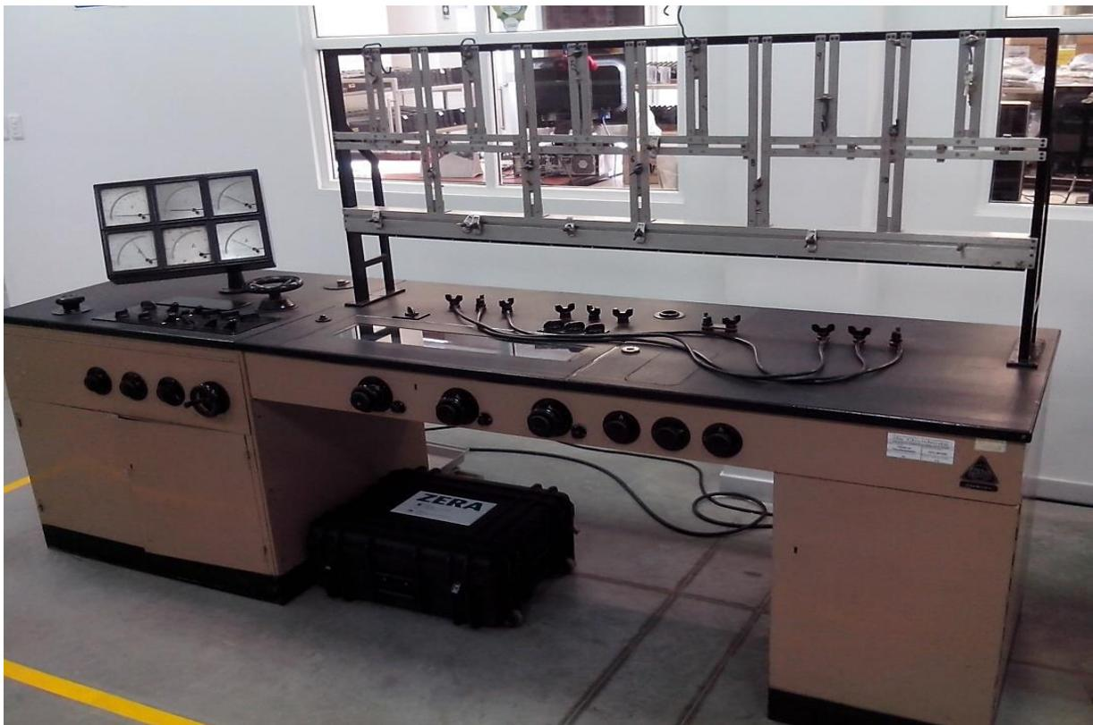
*Figura 6.* Mesa calibradora de medidores de consumo eléctrico que se desea repotenciar
