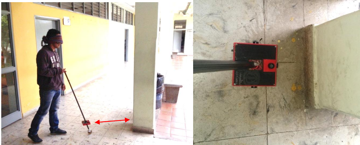
Imagen 73. Evasión de obstáculo, detección frontal Fuente: Elaboración propia
