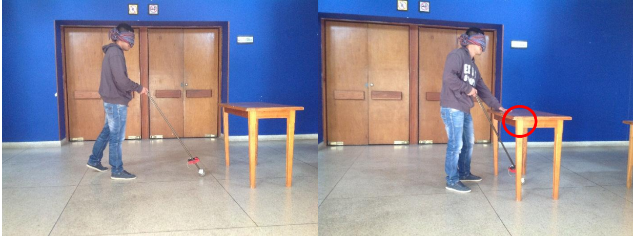
Imagen 71. Detección de objeto elevado Fuente: Elaboración propia
