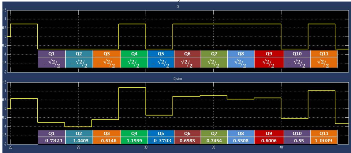
Figura 2.27. Señales de entrada y salida del canal AWGN para la modulación QPSK de las ramas a) I y b) Q para E_b/N_o igual a 7 dB
