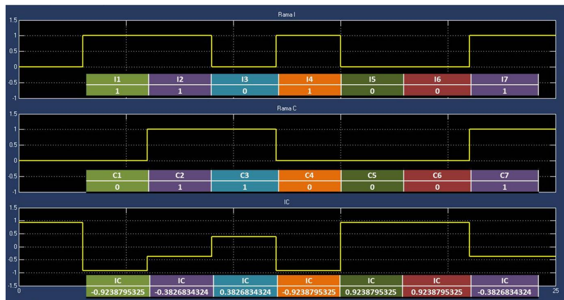
Figura 2.23. Señales normalizadas a la salida del Mapeador en las ramas a) I y Q para la modulación QPSK.
