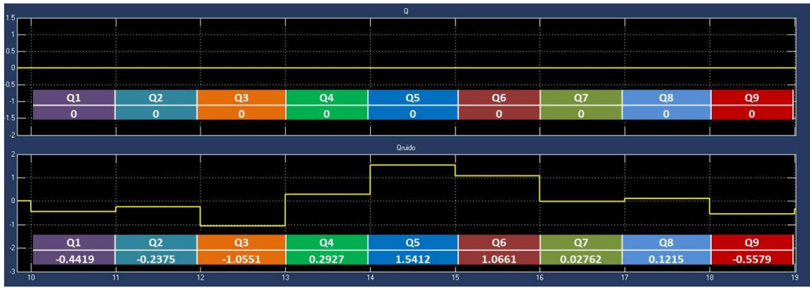
Figura C.17. Señales de entrada y salida del canal AWGN para la modulación BPSK de las ramas a) y b)Q para E_b/N_o igual a 7 dB
