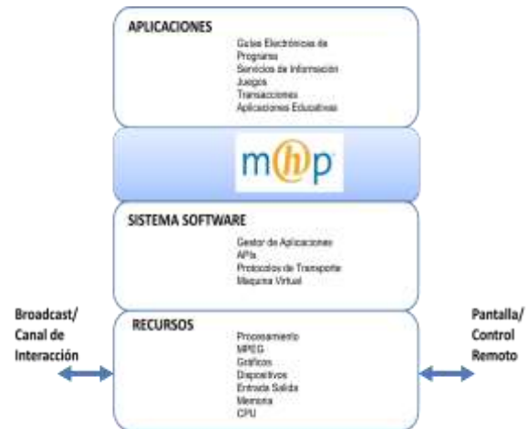
Fig. 4 Arquitectura de la Plataforma MHP. Tomado de [15].
