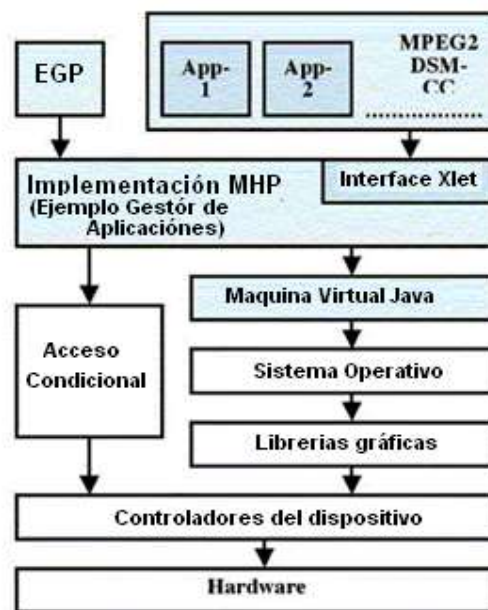
Fig. 2 Estructura Simplificada de MHP. Tomado de [10].
