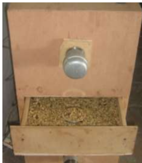
b. Camara plenum con café en el silo
