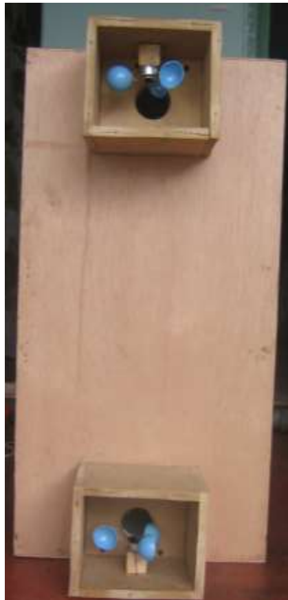
Figura 17. Instalación Anemómetros en el silo
