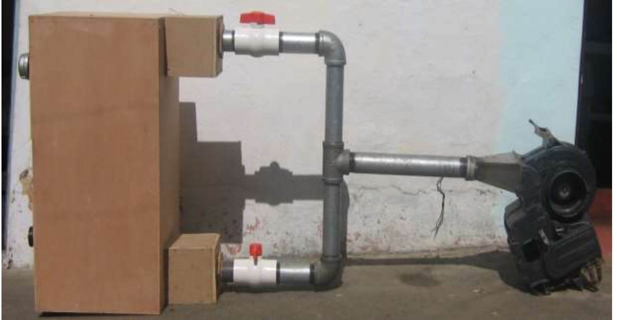
Figura 11. Maqueta del silo tipo Cenicafe
