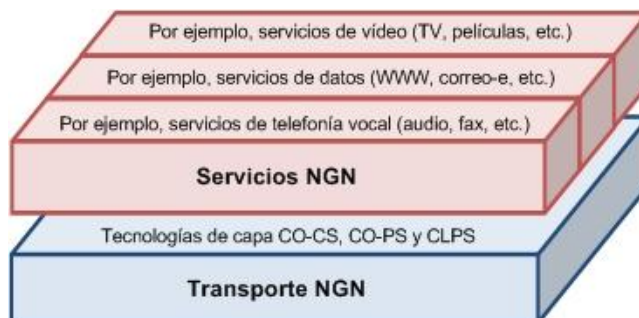
Figura 3 Separación entre servicios y transporte en la NGN Fuente: ITU 8
