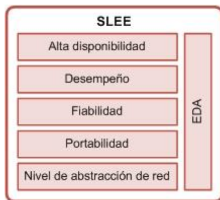
Figura 17 Criterios técnicos clave para un SLEE
