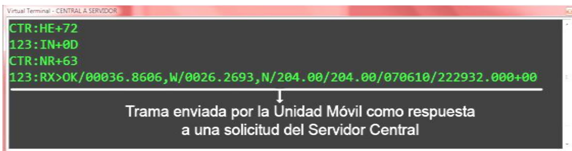
Figura 3.38. Ejemplo de implementación de una trama en HORUS.
