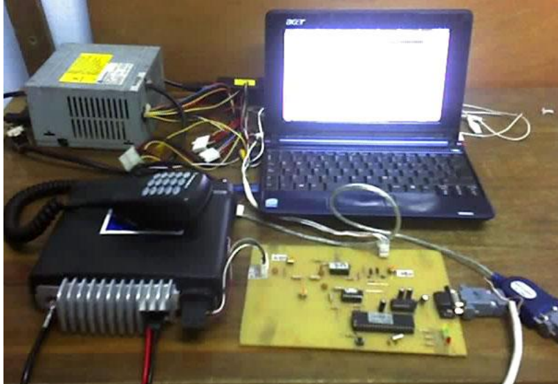
Figura 4.4. Radio móvil, computador y tarjeta de UCCA-EC en la estación de control.
