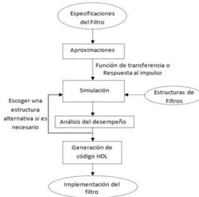
Figura 3. 13 Pasos en el diseño de filtros digitales FIR e IIR [16]
