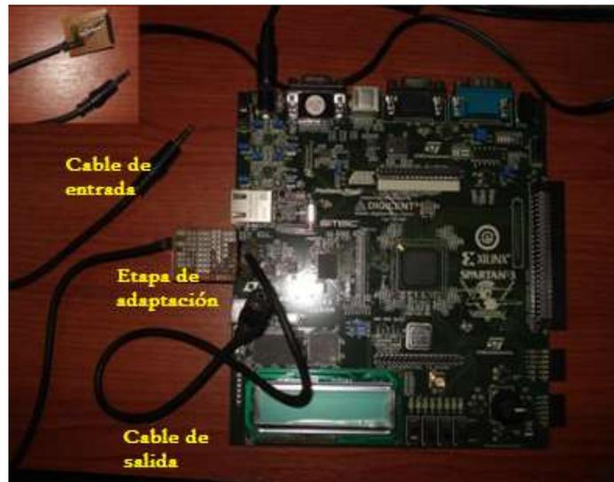
Figura 4. 7 Integración de FPGA con etapa de adaptación y los parlantes
