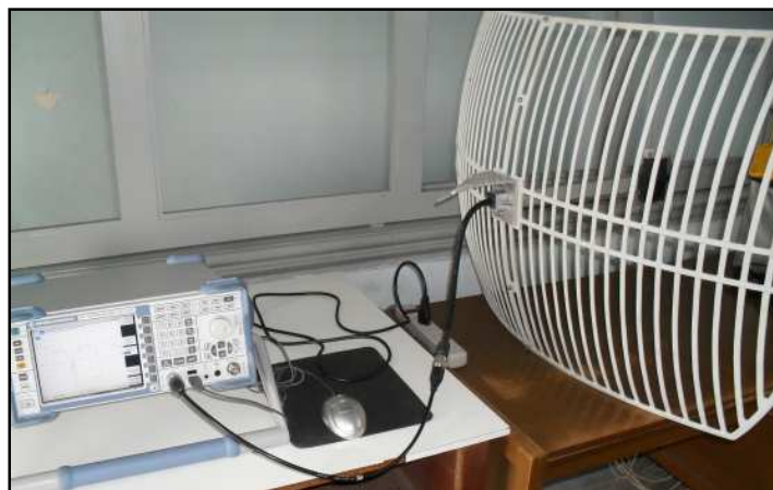
Figura 30: Montaje antena tipo grilla HG2424G
