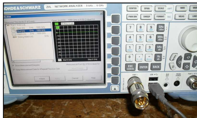
Figura 62: Conexión del estándar Open en el puerto uno
