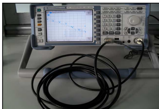
Figura 5.6: Conexión del cable coaxial RG-58 al VNA
