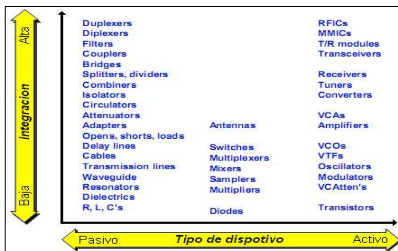
Figura 3.1: Clasificación de dispositivos de RF [18]
