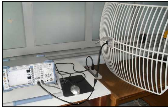
Figura 5.40: Montaje para realizar medidas antena grilla
