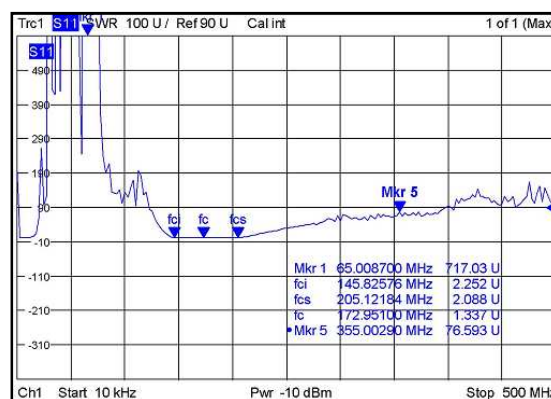
Figura 5.24: Medida de SWR para el filtro, de 10KHz a 500MHz
