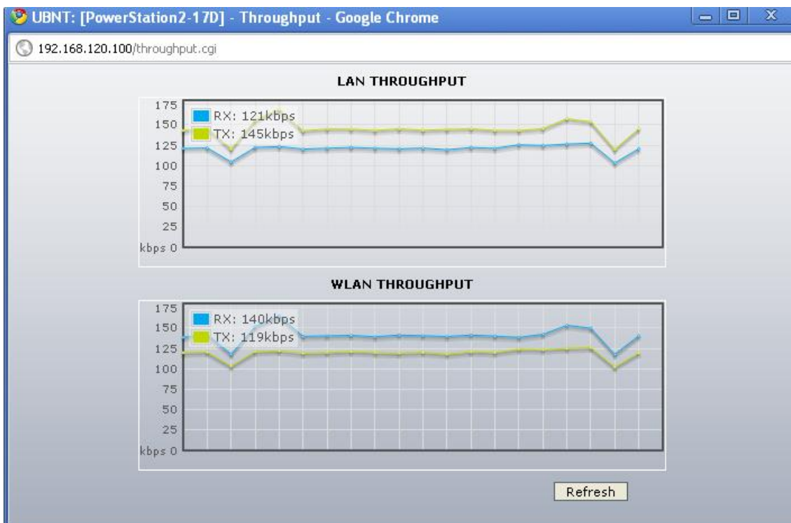
Figura 198. Throughput para el canal 5 para 192.168.120.100
