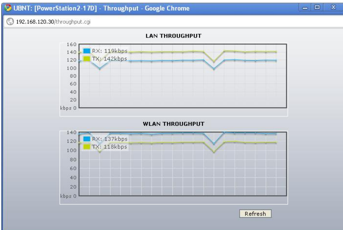
Figura 20. Throughput con el modo 802.11b/g para 192.168.120.30
