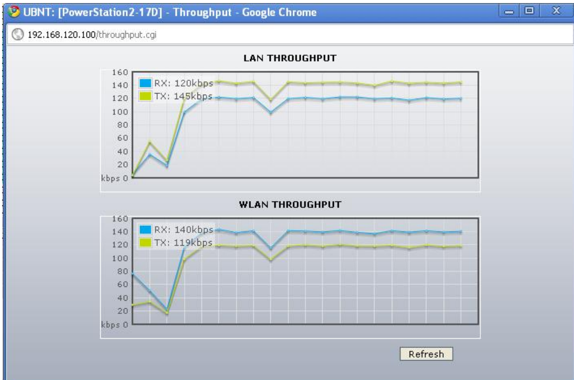
Figura 19 Throughput con el modo 802.11b/g para 192.168.120.100
