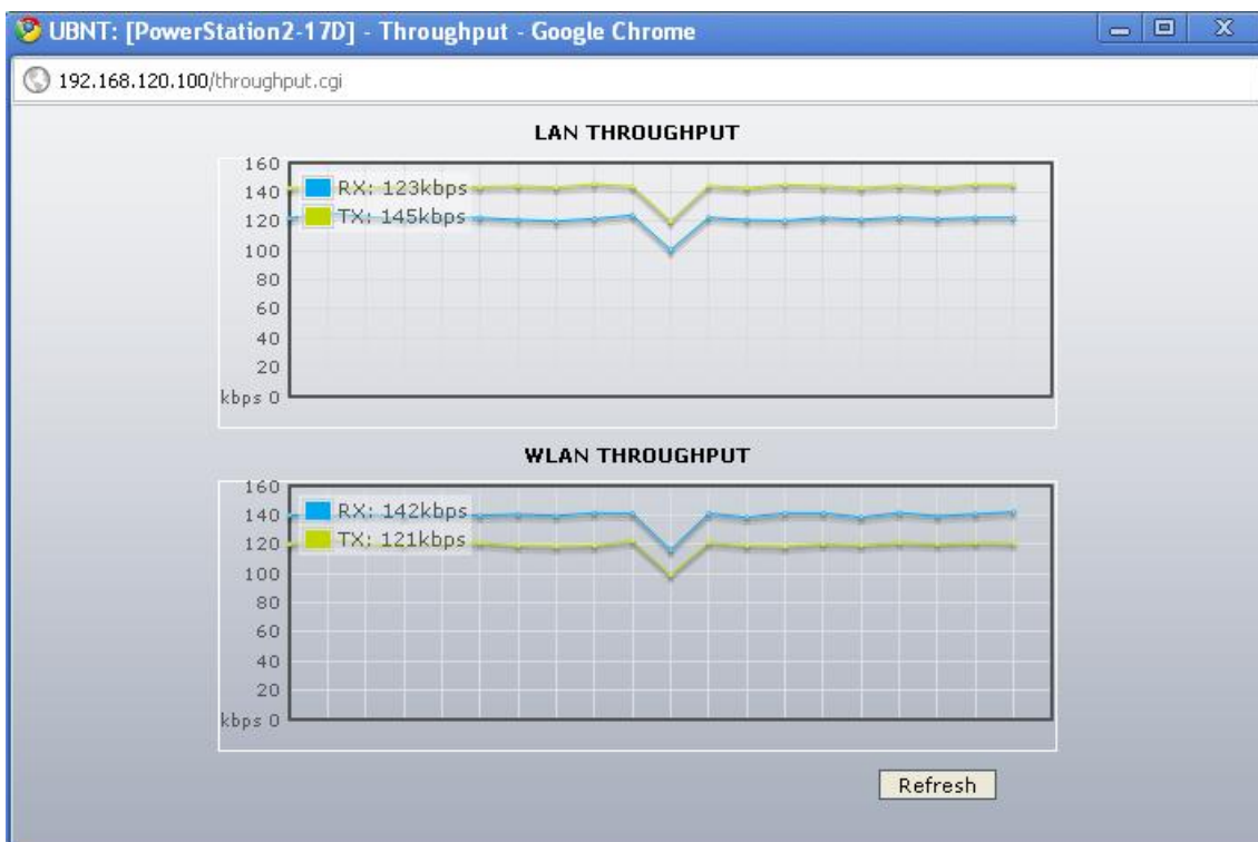
Figura 73. Throughput para inmunidad al ruido con el AP habilitado y estación canal de salto de señales para 192.168.120.100
