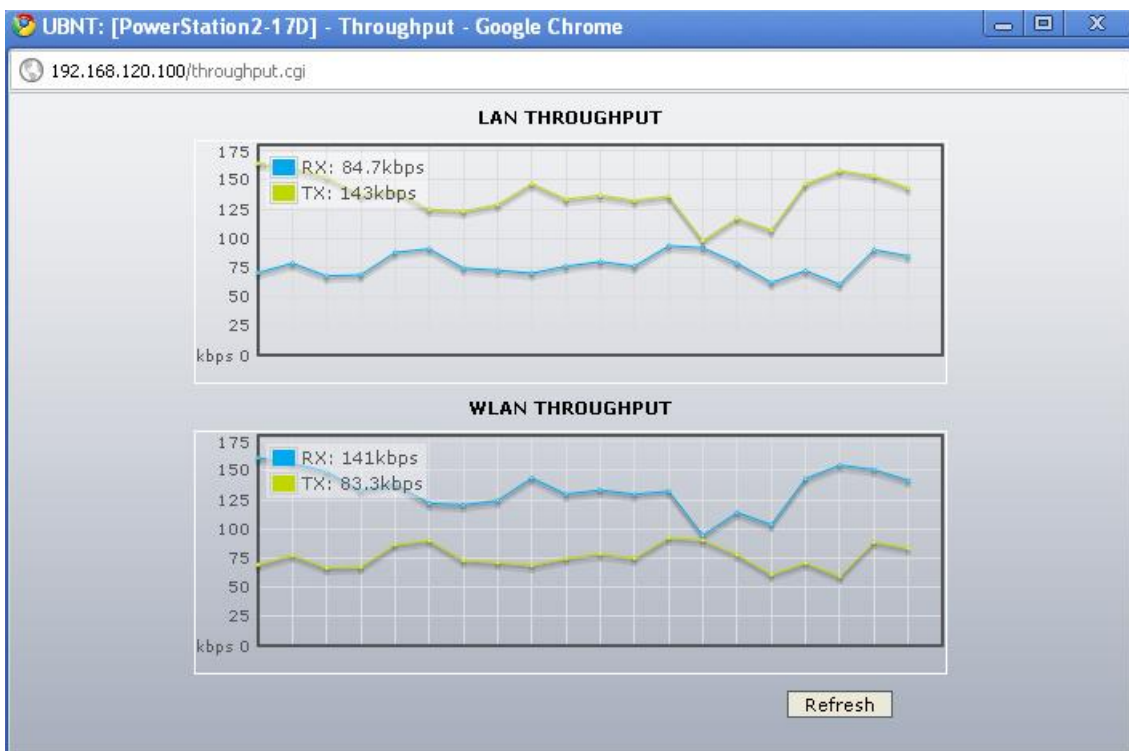
Figura 83. Throughput para la característica súper G en modo marco rápido para 192.168.120.100
