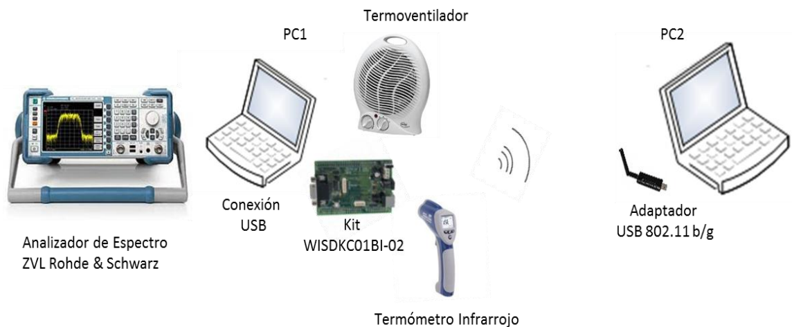
Figura 3.11. Esquema para la medida de la estabilidad en frecuencia
