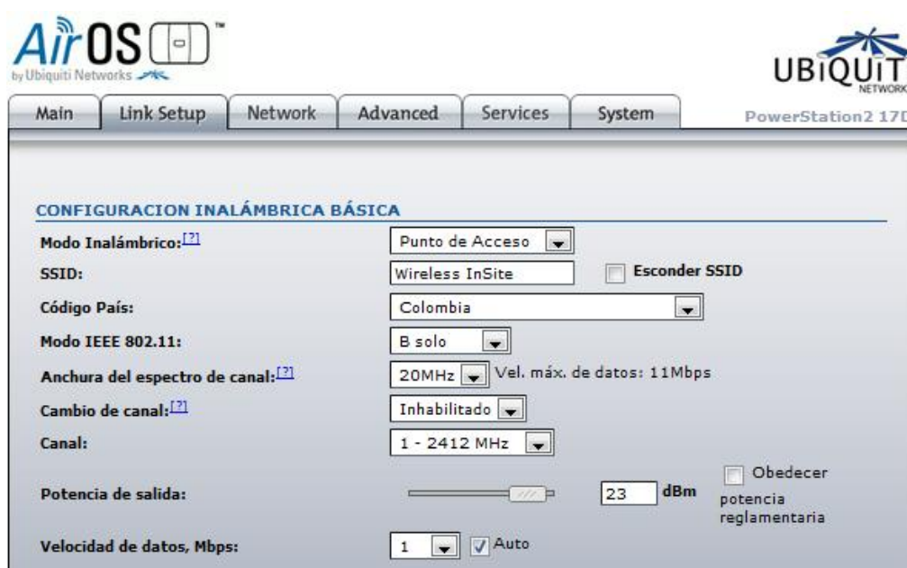
Figura B. 7 Configuración de la pestaña “Link Setup” para la plataforma inalámbrica transmisora
