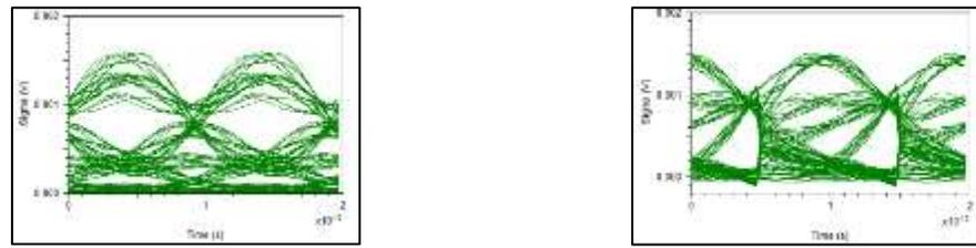
Figura 3.105. Diagrama del ojo de la técnica de post-compensación electrónica para la CD mono canal y formato de modulación NRZ-OOK a) sin EDC, b) con EDC basada en un ecualizador DFE en el lugar del receptor. Número de taps: 6 en la sección FFE y 2 en la sección feedback. Longitud 120 km de SMF-28.
