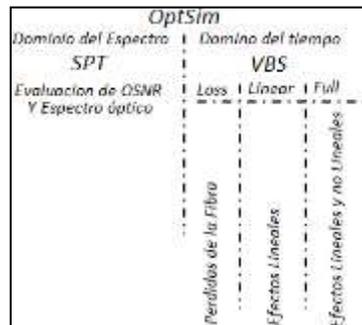
Figura 2.1. Técnicas de simulación de la Herramienta OptSim® [57].
