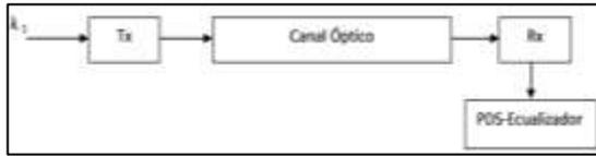
Figura 1.13. Técnica de compensación electrónica para la CD aplicada en el lugar del receptor de una red WDM [37].
