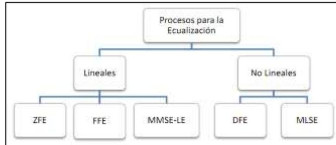
Figura 1.16. Procesos lineales y no lineales para la ecualización del canal óptico [37,38].
