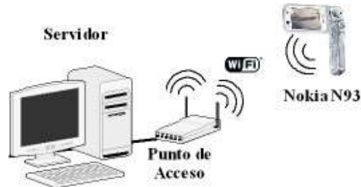
Figura 4-24. Entorno de pruebas WiFi
