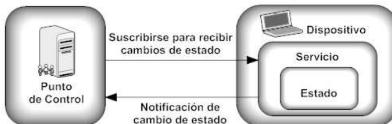
Figura 2-9. Funcionamiento de UPnP, durante el control/visualización
