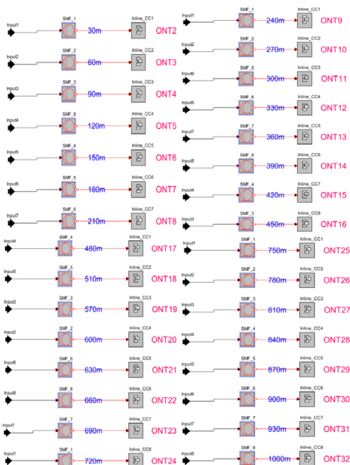
Figura 4.10. Configuración de distancias para 32 usuarios.
