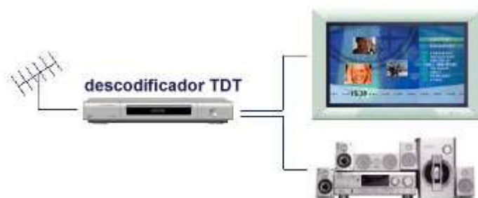
Figura No 28. Diagrama general para la recepción de TDT en un televisor convencional.
